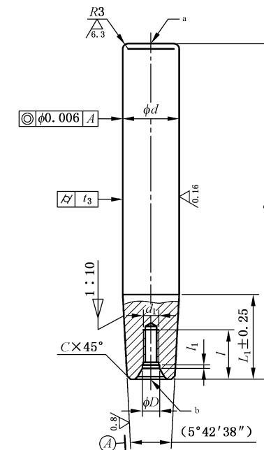
未注表面粗糙度  $R_a 6.3 \mu\text{m}$ 。
